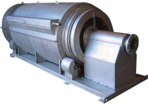
Los filtros rotativos de alimentación interna Serie BRS son equipos versátiles que se utilizan para altos caudales con elevados contenidos de sólidos. La principal ventaja de esta serie es un diseño compacto con componentes montados sobre una sólida estructura. El filtro puede ser ranurado, perforado o de malla. El tambor rota sobre cuatro ruedas, es conducido por un motoreductor TEFC con cadena de inoxidable y esta equipado con una barra de limpieza externa.
